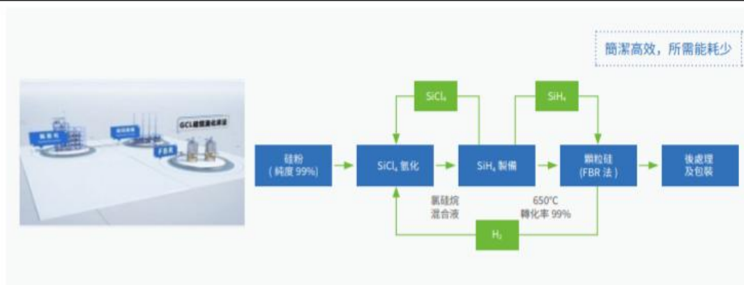
图：硅烷流化床法工艺流程
